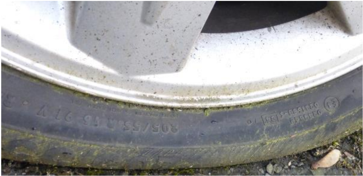
Podhuštěné pneumatiky na bocích drobné praskliny.
