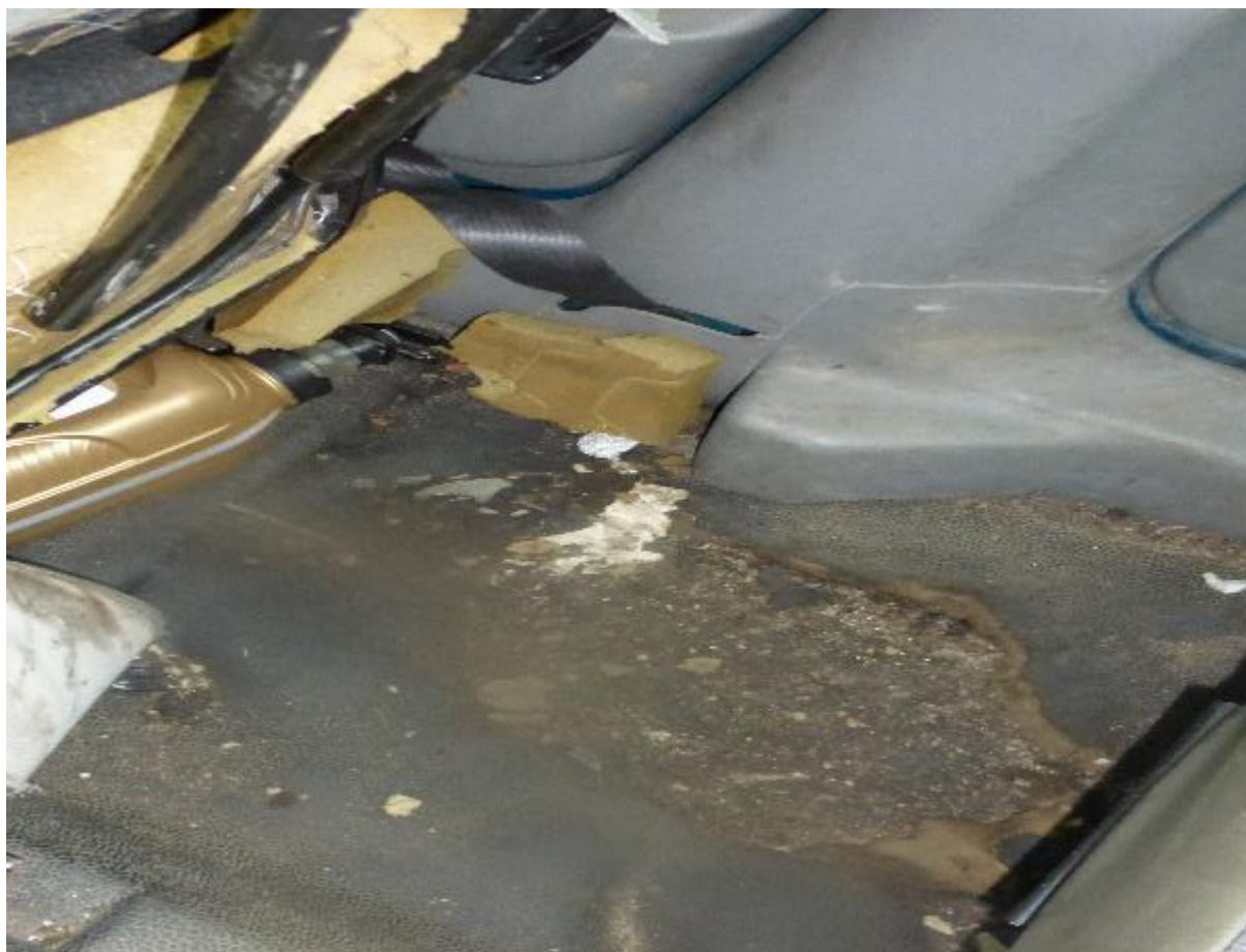
Prosezená sedačka, poškozené opěradlo řidiče, ztížen posun sedačky.
