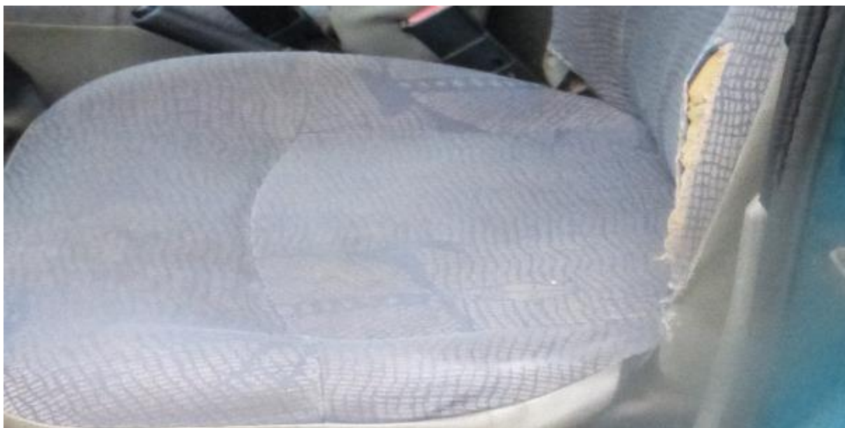
Prosezená sedačka, poškozené opěradlo řidiče, ztížen posun sedačky.
